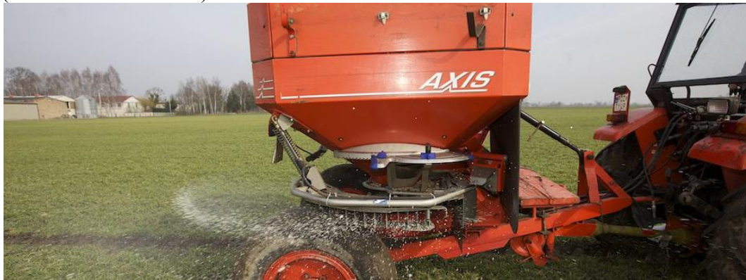
urządzenie do nawożenia (rozsiewacz nawozów)
